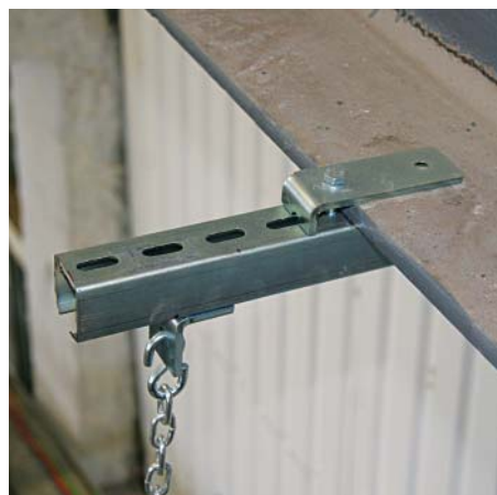
Использование С-обр. профиля для подвеса на балку
