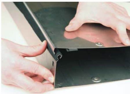
Защелкивание крышки происходит путем сдвливания внутрь боковины лотка
